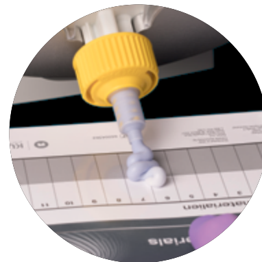
Slika 63: Odbacivanje početnih 2-3 cm za prilagodbu razina punjenja dviju komponenti materijala.
